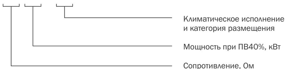
Например: РДТ-8,0-20-УХЛ2: резистор динамического торможения, сопротивление 8 Ом, мощность 20 кВт, исполнение УХЛ2.
